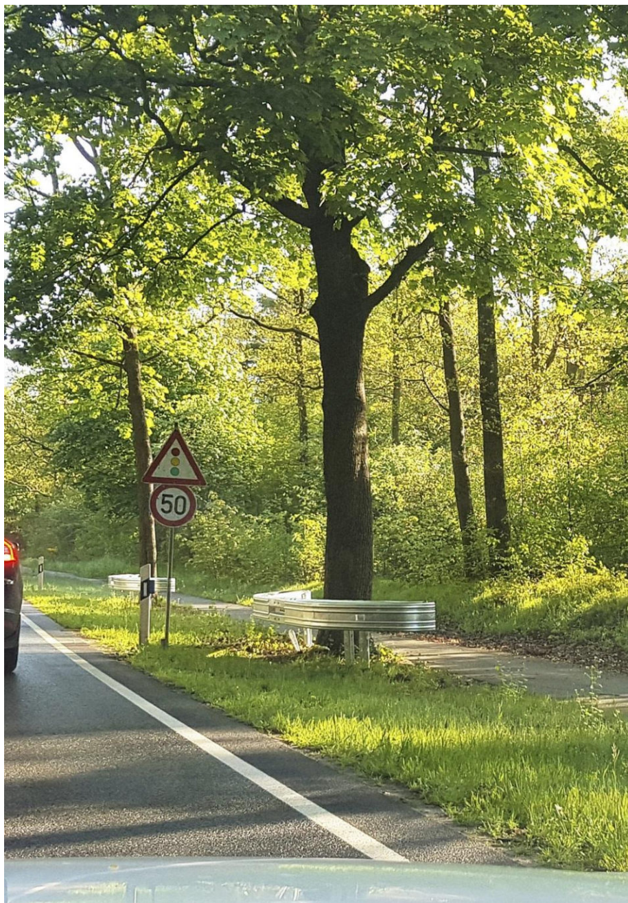
Rys. 23. Bariery drogowe osłaniające pojedyncze drzewa, Dolna Saksonia, Niemcy (Źródło: https://www.nabu.de/umwelt-und-ressourcen/verkehr/verkehrsinfrastruktur/12571.html )
